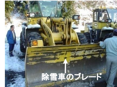
写真-1 除雪車の概要
