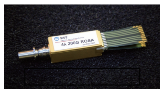
図1 開発した4チャンネルAPD-ROSAの構成と外観
