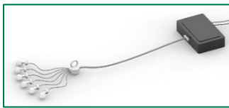
図1: 心音収集部のプロトタイプ
