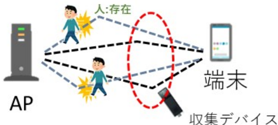
図 2 CSI に基づく物体検出技術の仕組み
