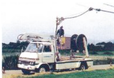
図2 ケーブル架渉車 (1976)
