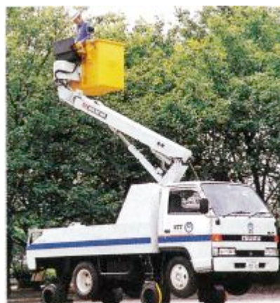
図 7 移動式バケット車（スカイムーバ）
