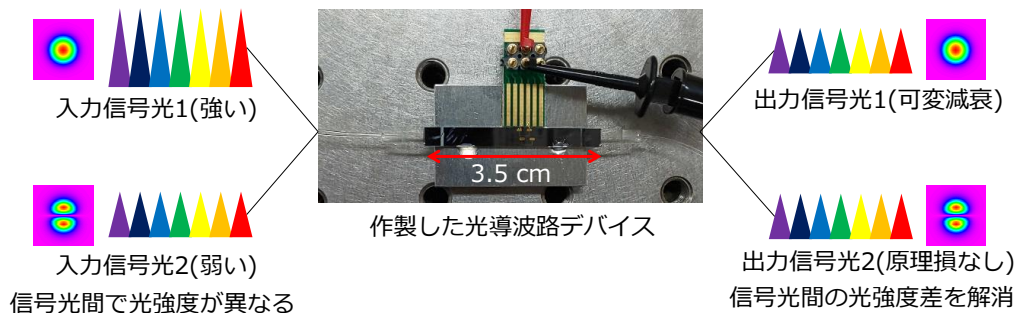
図1 作製したデバイスの外観と信号光間の光強度差の低減イメージ
