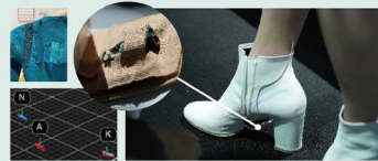
加速度マイクとトラッキングによる振動計測 Vibration measurement using an accelerometer and tracking
